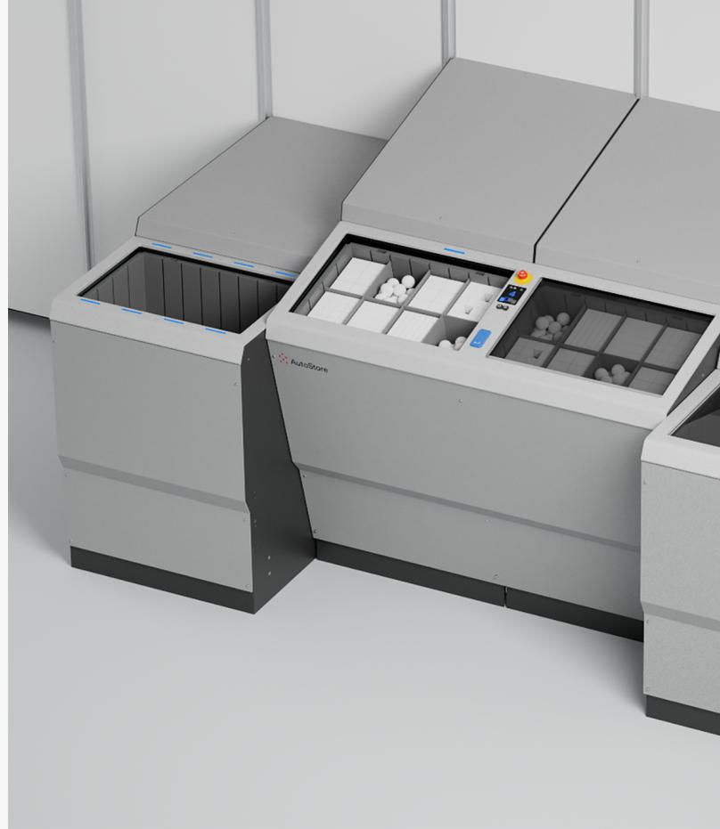
オペレーターは、ソースビン開口部から商品をピックアップしたあと、ターゲットビン開口部に移動してステージングを行います。すべての商品が対象のビンにまとめられると、顧客の注文品の準備が完了します。このビンは、システムが自動的にグリッドに戻して保管し、配達やピッキングを待ちます。この合理的な設計により、他のAutoStoreワークステーションよりもさらに効率よくオーダーを処理できるようになります。
